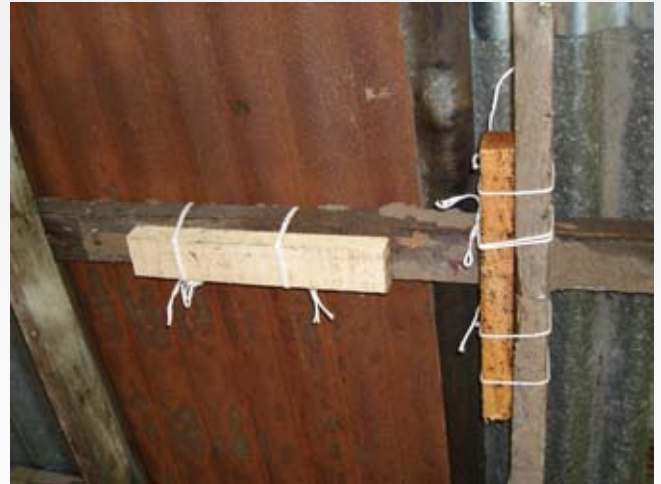
2 นำไม้ยางพาราที่ทำด้วยบอรา-แคร์ 1 : 1 (ไม้ขึ้นขวามือ) และไม้ได้ทาบอรา-แคร์ (ขึ้นด้านซ้ายมือ) ประกบเข้ากับไม้แปรรูปที่มีปลวกอยู่และวางทอทางเดินของปลวก เพื่อให้ปลวกกัดกินไม้เป็นเวลาประมาณ 3 เดือน
